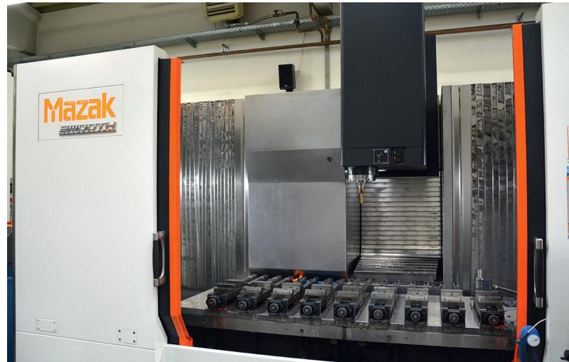
**3** Sprung in eine bessere technologische Wettbewerbssituation: ZTS gewinnt dank des 5-Achs-BAZ VTC-800/30SR an Arbeitsraum und Leistung in Bezug auf noch komplexere und größere Bauteile © Hanser
