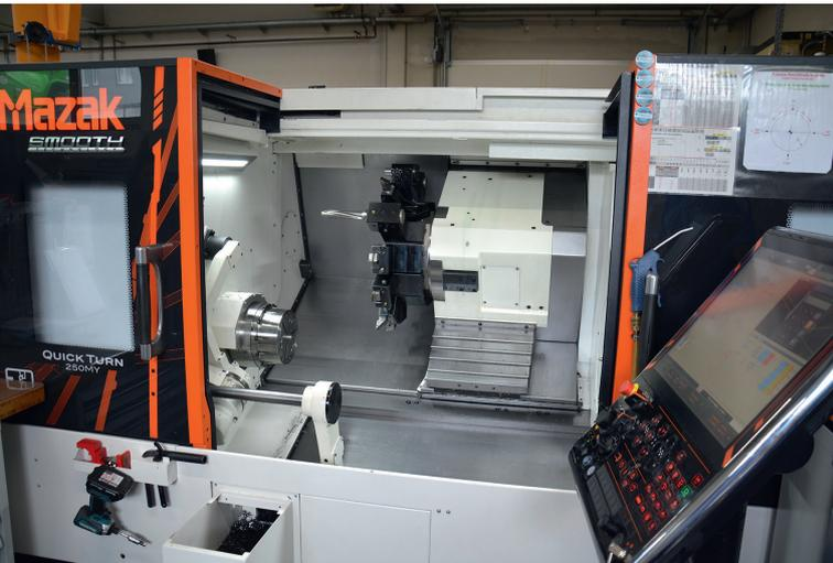
**2** Erweitert das Auftragspektrum enorm: Die neue Quickturn 250 MY bietet mit einem Stangendurchlass von 80 mm und einer Y-Achse weitreichende Anwendungsoptionen für ZTS © Hanser
